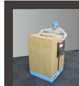
④ センターラインを合わせながら、トップブリッジを横荷に被せます。
