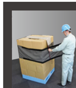
⑦ メインベルトをフラットバックルに通します。
