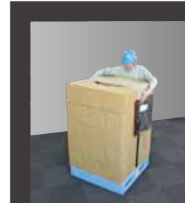
④センターラインを合わせながら、トップブリッジを積荷に被せます。
